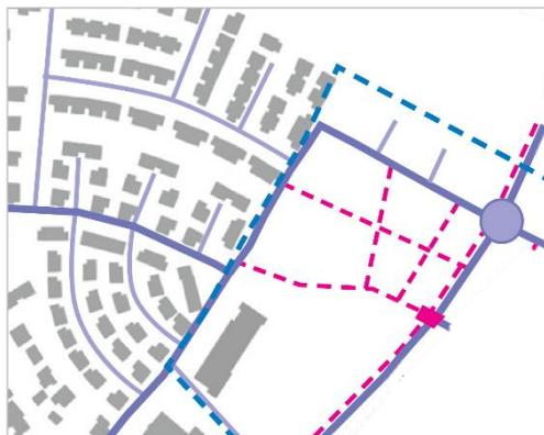
*Schematische Darstellung der geplanten Erschließung mit dem Kreisverkehr im Norden, der Haupterschließung nach Westen sowie dem getrennten Fuß- und Radwegesystem (Quelle: Städtebaulicher Entwurf, Stand Oktober 2019)*
