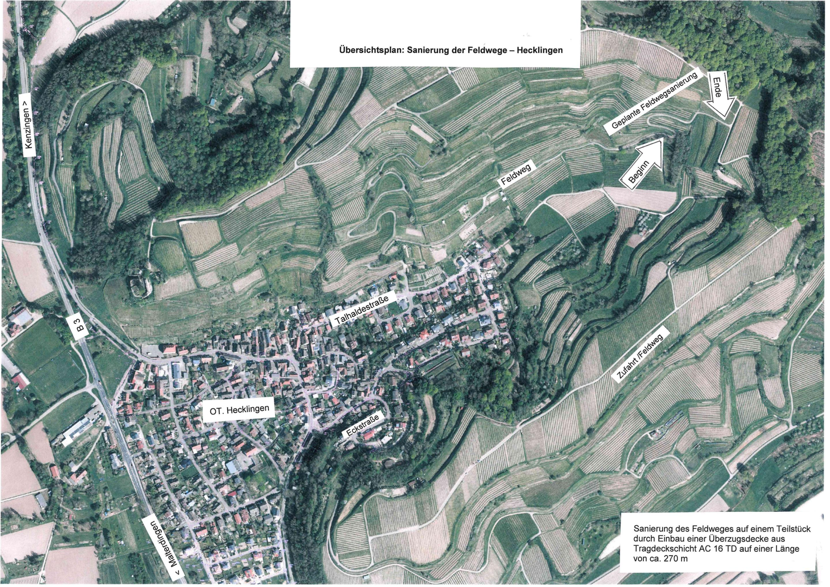
Sanierung des Feldweges auf einem Teilstück durch Einbau einer Überzugsdecke aus Tragdeckschicht AC 16 TD auf einer Länge von ca. 270 m
